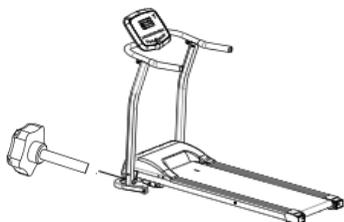
Шаг 3: Используйте фиксатор М8\*70 для фиксации рамы в таком положении
